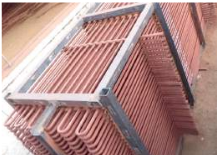
Economiser Coil | SA 210, Gr A1, Carbon Steel
